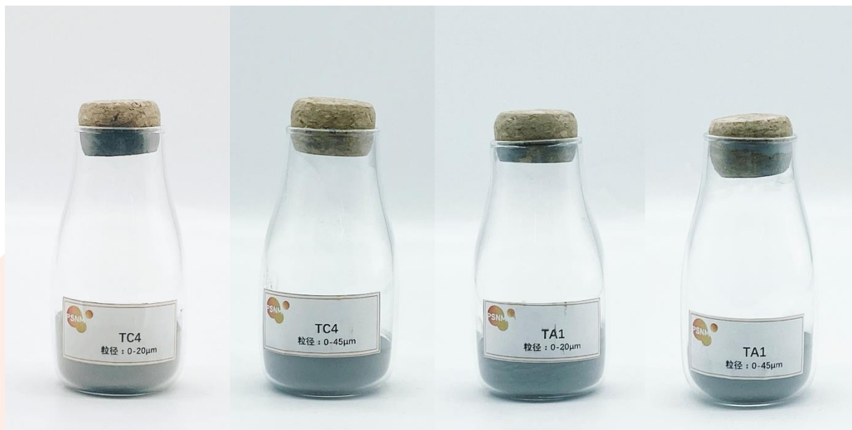
图 4 盘星新金属生产 MIM 钛合金粉末
